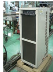
冷却水再生装置
