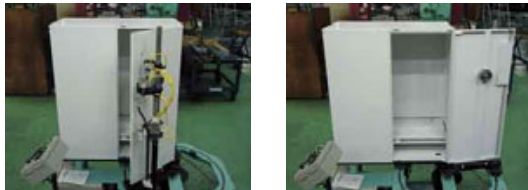
耐久試験用の自動開閉装置
