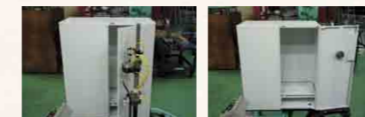
耐久試験用の自動開閉装置
