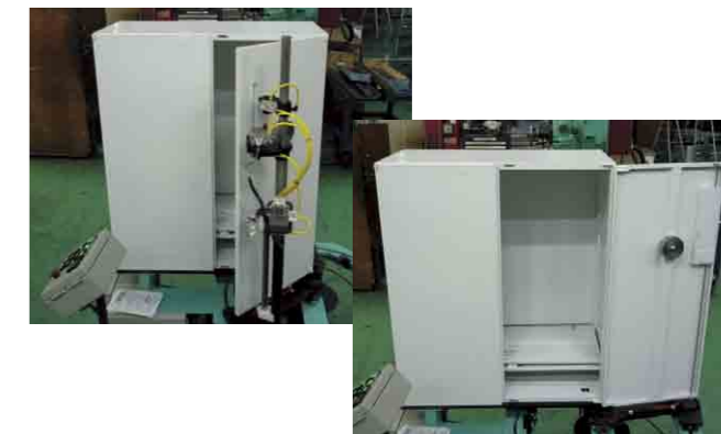
耐久試験用の自動開閉装置
