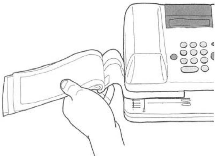
※印字をした後、その金額が間違ったときは、④キーを押して表示を0にし、用紙を再セットして、抹消キーを押します。図の様に抹消されます。
