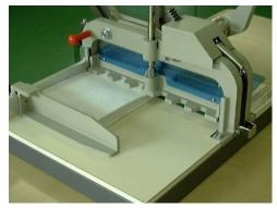
1. まず断裁機に用紙をセットします。ゲージを使用し、断裁位置を決 めます。
