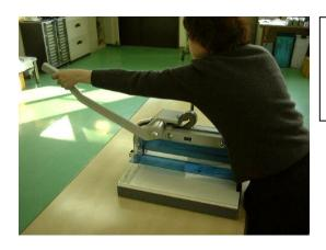
8. 断裁が完全に終了しましたら、レバーハンドルを上に上げます。 この時もクラッチを切り替える動作をします。この操作は、断裁の 時と逆になり、レバーが真上に来たらクラッチを切り替えるように します。この操作をしない場合は、レバーハンドルが 180 度反対 まで行ってしまいます。
