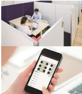
「RoomSense(ルームセンス)」は、予約せずに利用するミーティングコーナーや打合せスペース、などの利用状況を、ブースにあるセンサーが人を検知して LED ライトやサイネージで可視化するシステムです。離れた場所から事前に空き席がわかり、場所を簡単に探せます。また、履歴データは稼働状況の確認や施設設計に活用できます。
