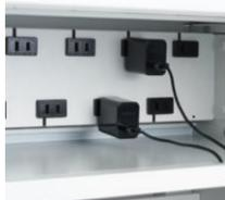
ACアダプタの取付や取外しがしやすい個別コンセントタイプをお勧めします。前面から作業も可能です。OAタップの場合、設置状況によっては一度外したACアダプタを元通りに戻せなくなる場合があります。
