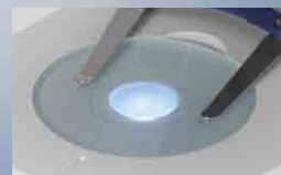
充電式照明装置 透過LED 下方からの照明で透過性の試料を見ることができます。
