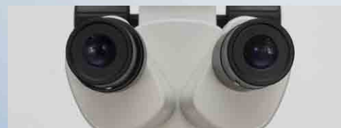
スライド式眼幅調節 直線上に眼幅を調節でき、試料を立体的に見ることができます。
