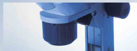
試料を探しやすい10倍採用(T34のみ) 総合倍率が10倍・20倍・40倍なので、試料を探しやすく、視野外に試料を逃しにくく、倍率を上げて観察することができます。
