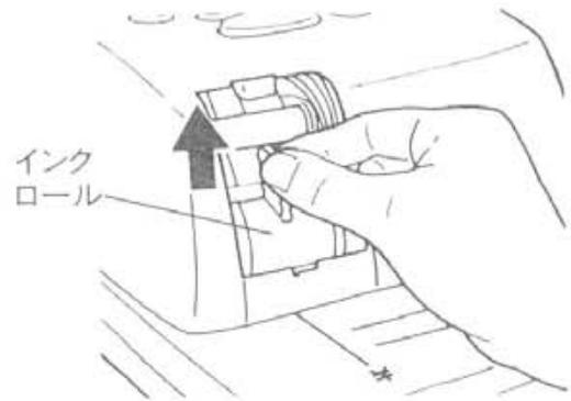
③新しいインクロールを図のようにセットします。
